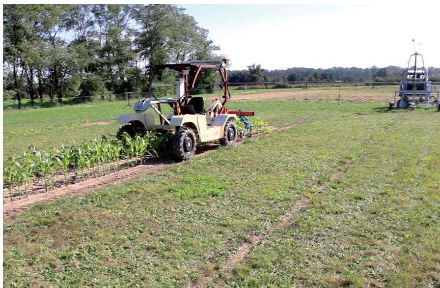
Estudio de un tractor eléctrico robotizado para la agroecología. © INRAE
